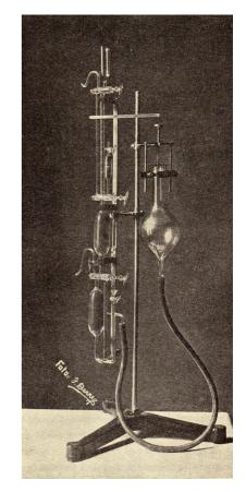
cuya posición permite volver a reponer la presión en la ampolla D por medio del mercurio que llega por H al elevar el depósito del mismo. Abriendo la comunicación de D con A se reúnen ambas porciones gaseosas que se envían a A, aumentando la presión, y que pueden separarse de la poca sangre o líquido que aun reste, dejando estos en D y cerrando oportunamente la llave 2.
