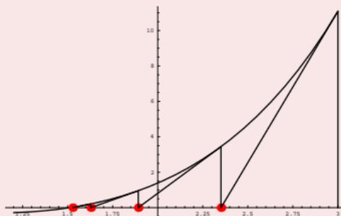
$x_{n+1} = x_n - \frac{f(x_n)}{f'(x_n)}$  converge –bajo condiciones de suavidad de  $f$ – a un cero de  $f$  que es punto fijo de la función  $g(x) = x - \frac{f(x)}{f'(x)}$ .
