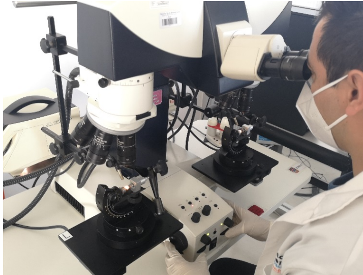
Imagen 6. Experto observando en un microscopio de comparación dos balas, para encontrar la mejor zona coincidente de las mismas. Fuente: Captura realizada por el autor.
