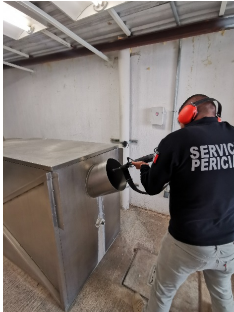
Imagen 1. Perito disparando en un tanque recuperador de agua, para obtener elementos balísticos testigos. Fuente: Captura realizada por el autor.
