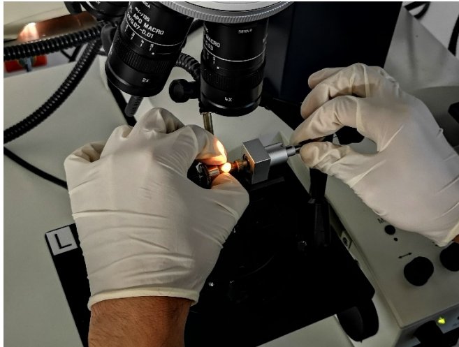
Imagen 5. Experto montando una bala en la platina izquierda de un microscopio de comparación. Fuente: Captura realizada por el autor.
