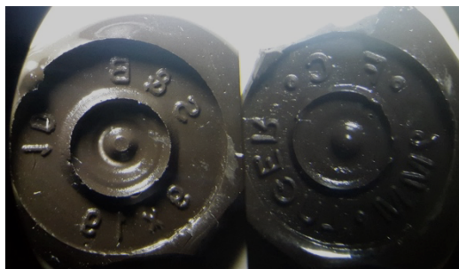
Imagen 10. Moldes de culotes de casquillos realizados con Mikrosil® en color negro. Fuente: Captura realizada por el autor.
