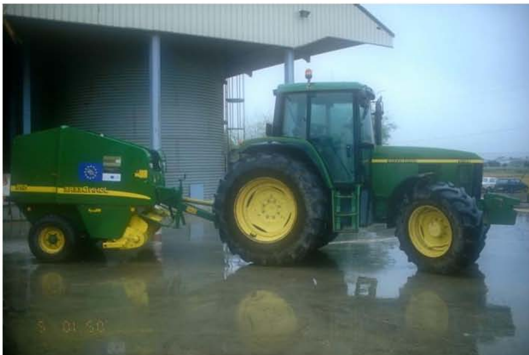
Imatge 4. Model de rotoempacadora modificada amb eix telescòpic. Font: Informe final de l'empresa FERVASA del projecte BIOCOMPOST.
