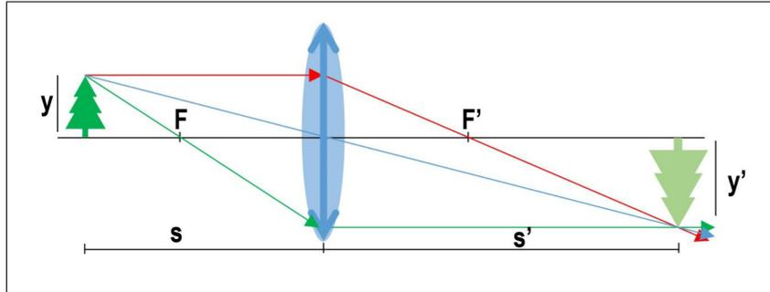
Figure 2: Trazado de rayos en una lente convergente para producir una imagen real e invertida.
