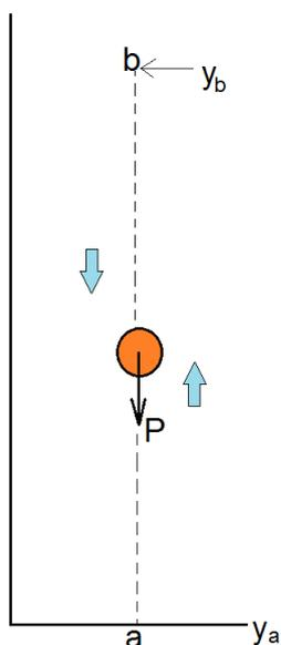
En la figura adjunta, a es el punto de partida, situado a una altura  $y_a$  respecto de la superficie, b es el punto más alto que alcanza el objeto, situado a una altura  $y_b$ . Vamos a determinar el trabajo que realiza la fuerza gravitatoria (peso) mientras el cuerpo sube y cuando el cuerpo baja.
