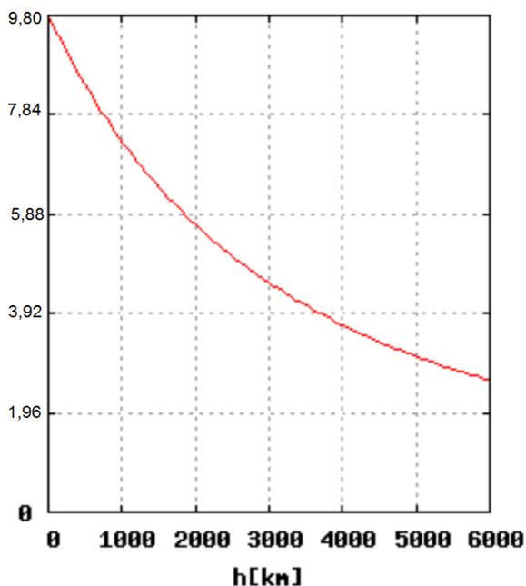
La representación gráfica de la variación de la intensidad del campo gravitatorio (módulo) en función de la altura en kilómetros se puede observar en la figura adjunta.
