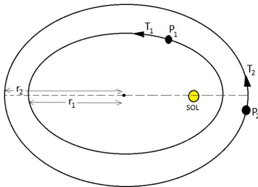
Supongamos dos planetas, P<sub>1</sub> y P<sub>2</sub> que describen dos órbitas con periodos respectivos T<sub>1</sub> y T<sub>2</sub> (figura adjunta). Según la tercera ley de Kepler se cumple que:
