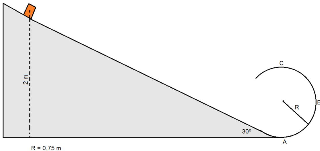
Dado que no existe rozamiento, la caída del objeto por el plano se debe exclusivamente a una fuerza conservativa, la gravedad. En estas condiciones se cumple el principio de conservación de la energía mecánica,
