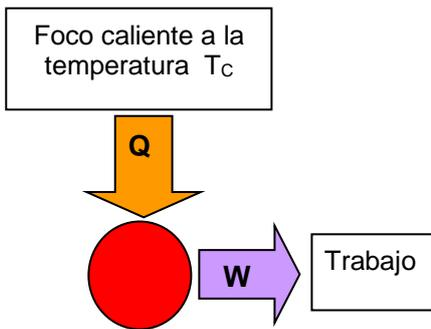
**Esquema de una máquina térmica que viola el Segundo Principio de la Termodinámica.**
