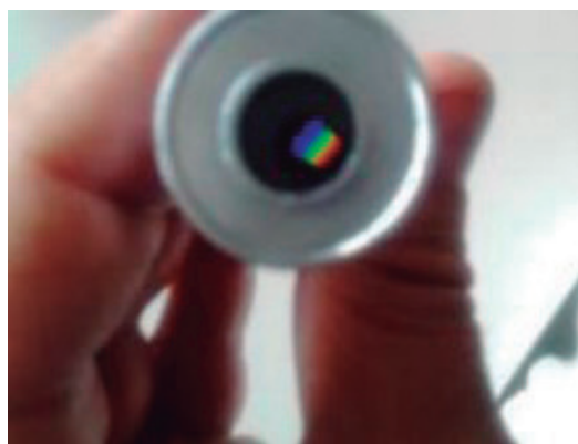
Imagen 1. Espectroscopio de bolsillo con espectro continuo de luz visible
