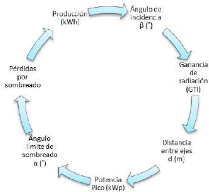
Proceso iterativo de diseño de los parámetros de una estructura fija [Ilustración 47]. Recuperado de: https://mecasolar.com/estructura-fija/
