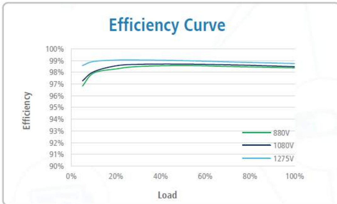
Ilustración 63: Curva de eficiencia del inversor de potencia SUN2000-60KTL-HV-D1-001
