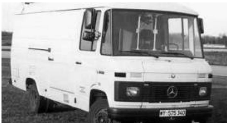
*Ilustración 3: Furgoneta Mercedes-Benz guiada por visión y computadora (cortesía de Cristina Sánchez)*
