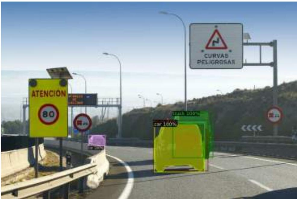
*Ilustración 49: Segmentación de la imagen 1 utilizando dataset de CityScapes en Detectron2*
