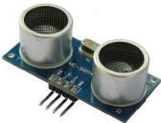
Ilustración 10: Sensor de ultrasonidos HC-SR04 (cortesía de tiendatec)
