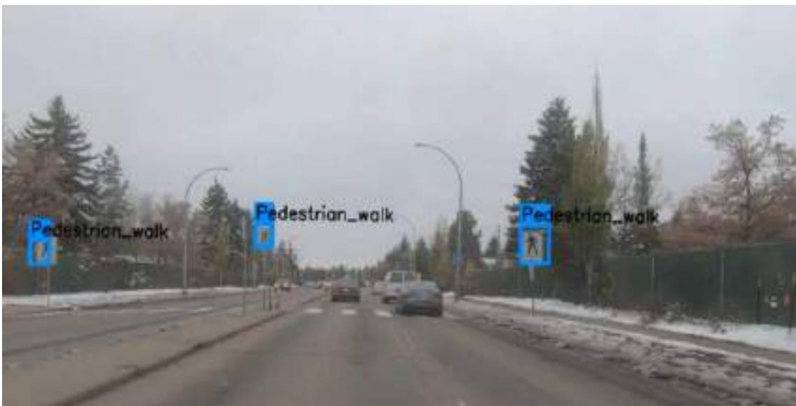
Ilustración 62: Muestra de la detección realizada con el dataset del repositorio sdbidon/ Traffic-Sign-Detection-using-YOLOv3
