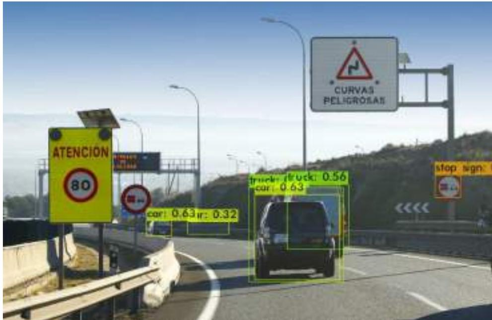
Ilustración 37: Detección imagen 1 en Darknet
