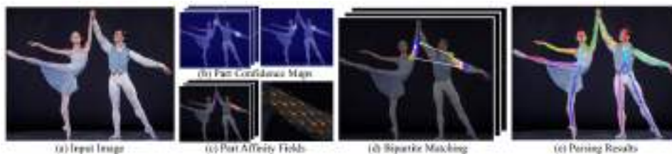
Figura 4.1: Pipeline de estimación de pose de OpenPose [16]
