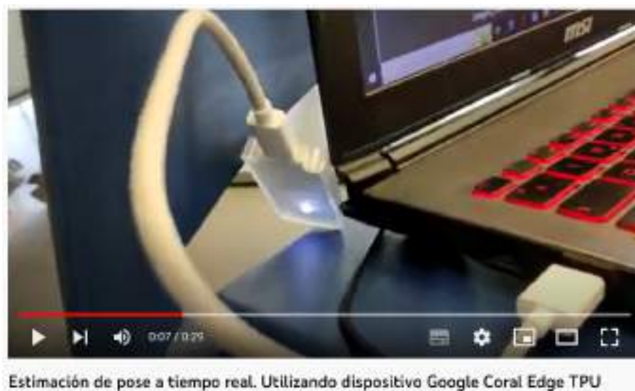
Figura 5.25: Comprobación funcionamiento de la TPU. LED intermitente del dispositivo (no apreciable en una captura) indica que se encuentra operativa
