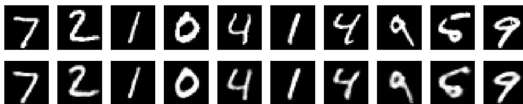
Figura 4.2: Ejemplo dígitos reconstruidos con estrategia de optimización quantization aware training . Imágenes originales arriba, reconstrucción abajo. Elaboración propia.
