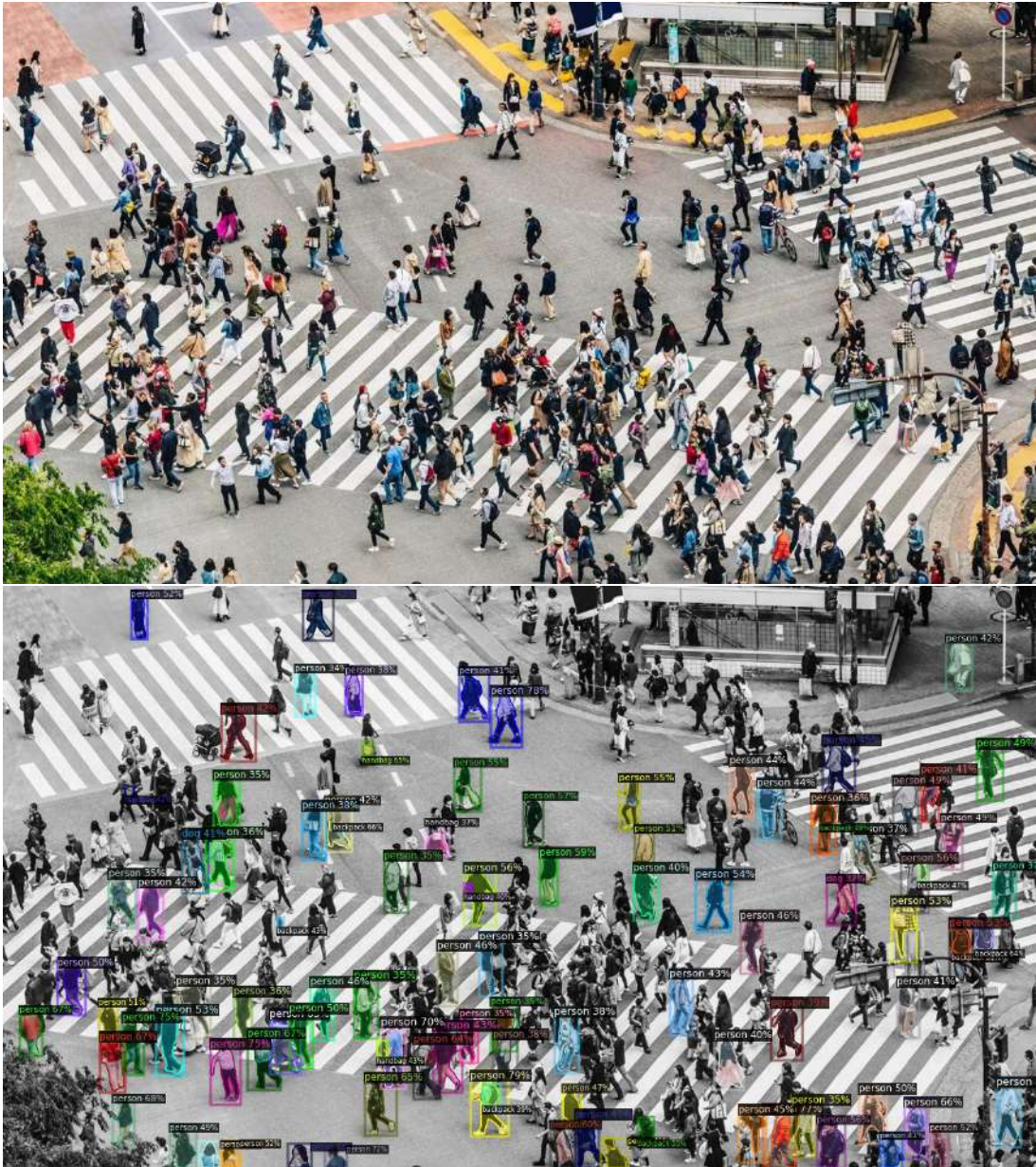
Figura 5.27: Ejecución del modelo Preentrenado COCO
