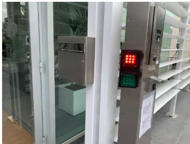
Figura 2.5: Sistema de control de aforo semáforo pase/espere
