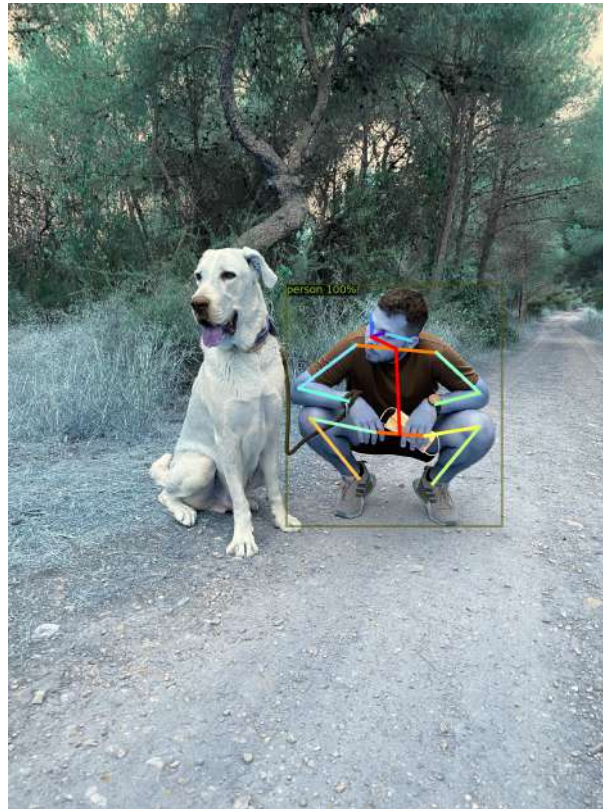
Figura 5.7: Estimación de pose con Detectron2 y keypoint_rcnn_R_101_FPN_3x.yaml y th=0.5
