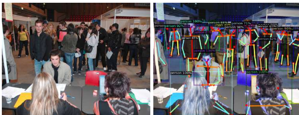
Figura 5.8: Estimación de pose con Detectron2 y keypoint_rcnn_R_101_FPN_3x.yaml y th=0.5
