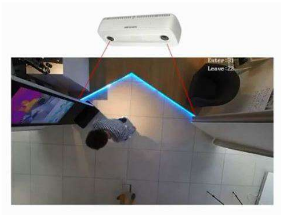
Figura 2.3: Sistema de control de aforo CA6826-ACR
