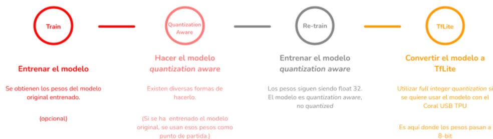
Figura 11 - Diagrama entrenamiento y cuantización modelo Tensorflow para Edge TPU.
