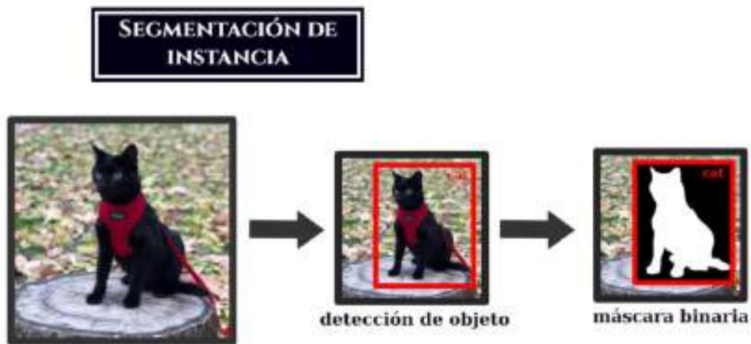
Figura 9: Ejemplo del funcionamiento y de la salida de la detección del modelo Mask R-CNN [6].
