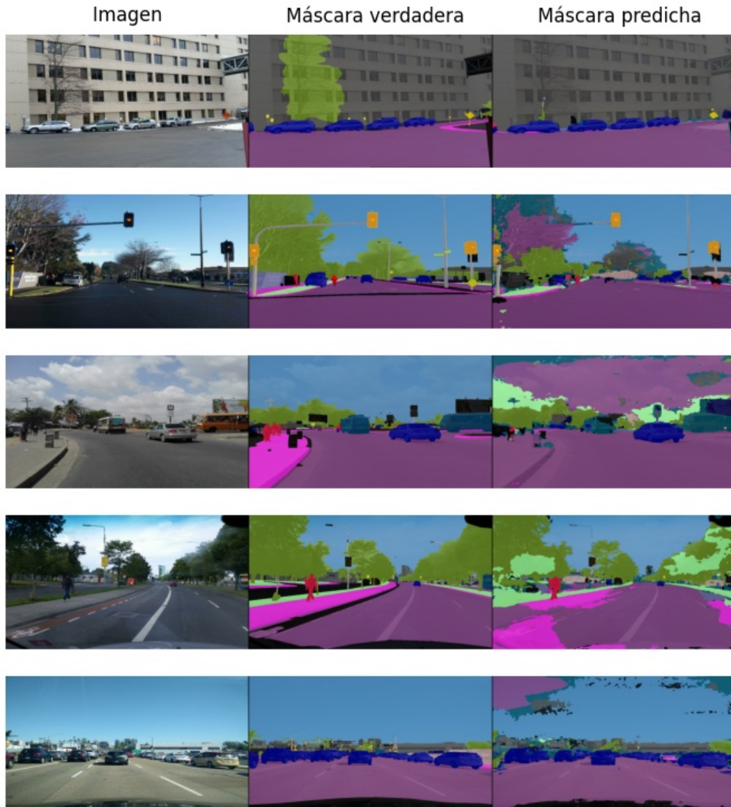
Figura 5.7: Máscaras de segmentación resultado de realizar inferencia del modelo Segformer MiT-B0 entrenado en GTA V sobre el dataset Mapillary.
