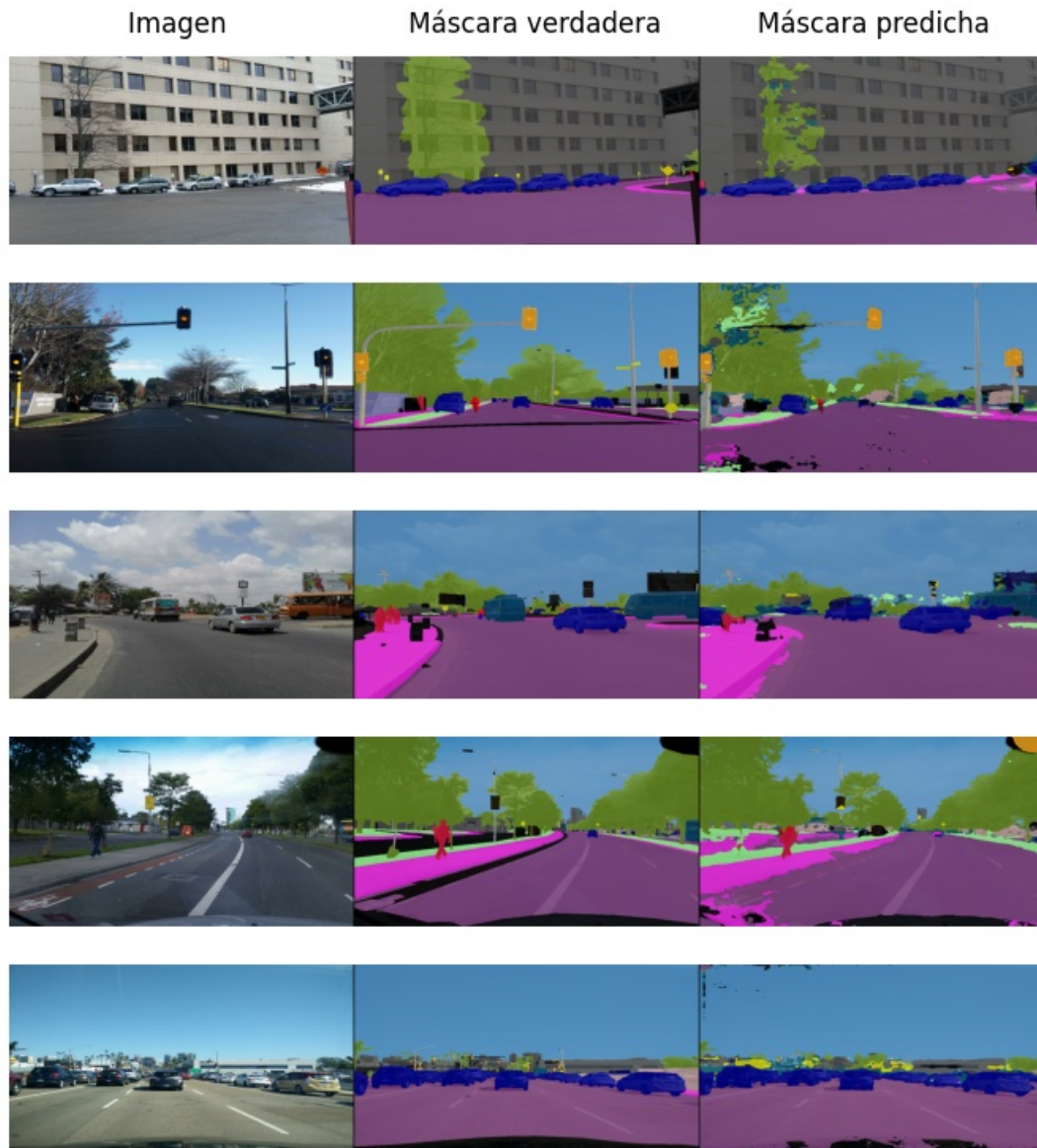
Figura 5.3: Máscaras de segmentación resultado de realizar inferencia del modelo Fine Tuning decoder GTA sobre el dataset Mapillary .
