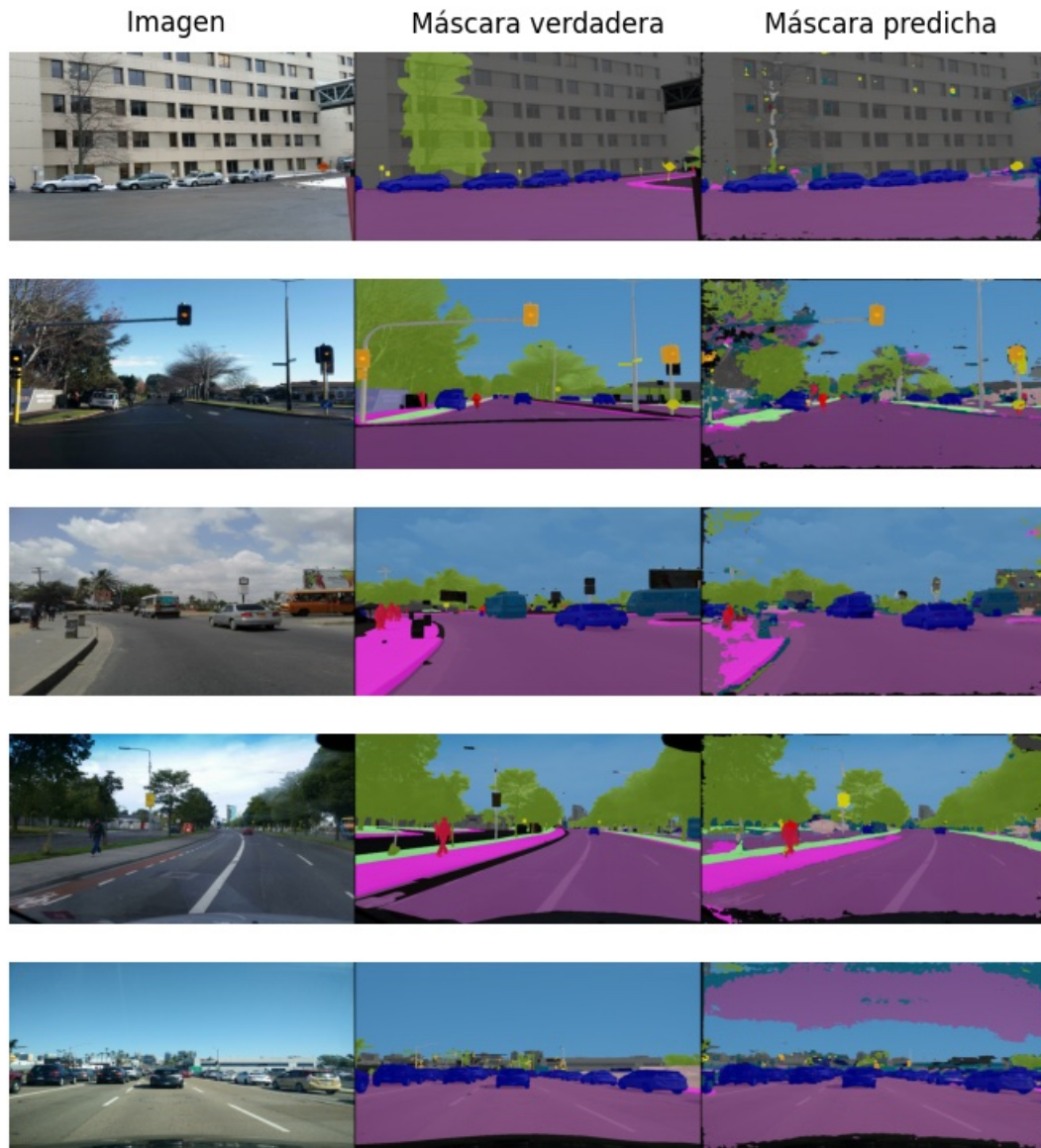
Figura 5.9: Máscaras de segmentación resultado de realizar inferencia del modelo sobre el dataset Mapillary.
