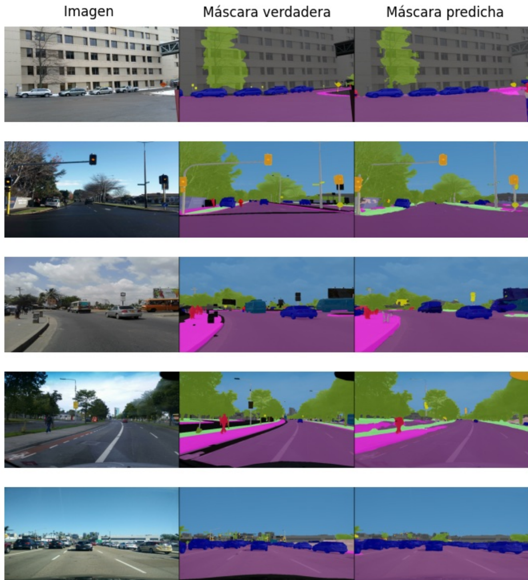
Figura 5.1: Máscaras de segmentación resultado de realizar inferencia del modelo preentrenado en Cityscapes sobre el dataset Mapillary.
