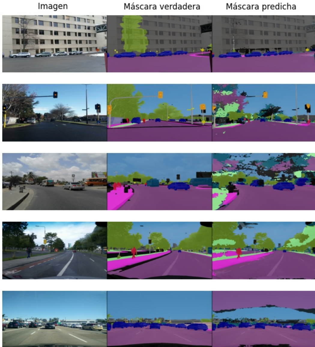
Figura 5.5: Máscaras de segmentación resultado de realizar inferencia del modelo Fine Tuning completo en GTA sobre el dataset Mapillary .
