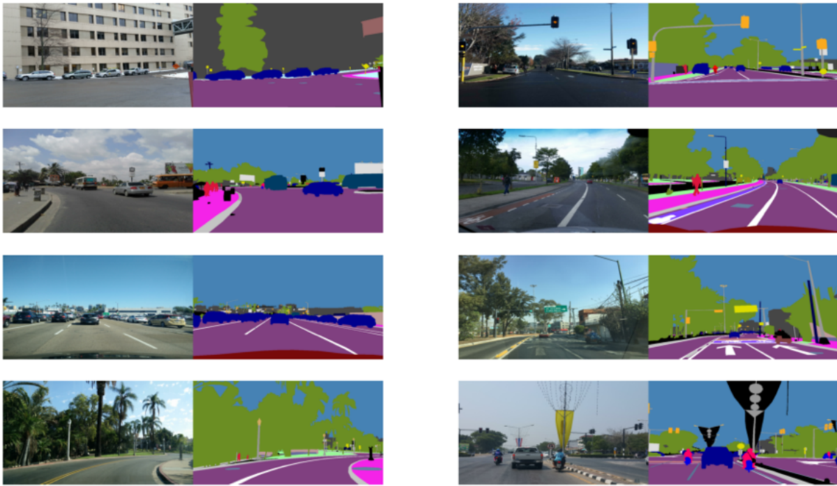
Figura 4.5: Ejemplo de varias imágenes del dataset Mapillary Vistas, cada una de ellas junto con su máscara de segmentación.
