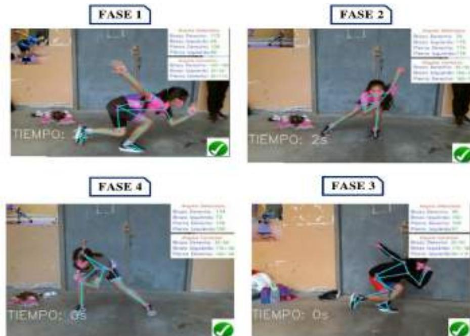
Figura 2 Imágenes de las fases de detección de postura y ángulos de patinadoras. En cada fase se detectan diferentes posturas y si se realiza de manera correcta, el sistema permite avanzar a la fase siguiente.
