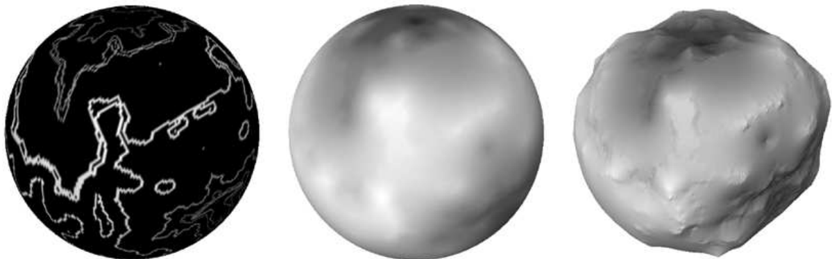
Figure 15: Interpolación de un modelo de elevación digital a partir de algunas curvas de nivel sobre la esfera. a) datos sobre la esfera, b) la interpolación AMLE, c) el mismo resultado representado como un grafo sobre la esfera.
