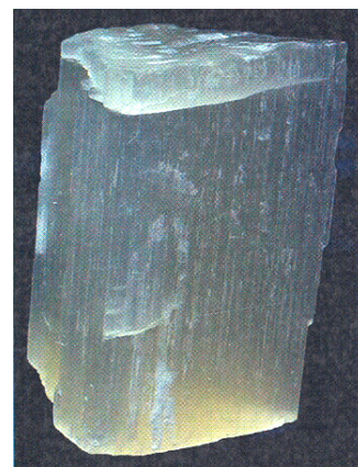
mineral trona \text{Na}_2\text{CO}_3 \cdot \text{NaHCO}_3 \cdot 2\text{H}_2\text{O}
