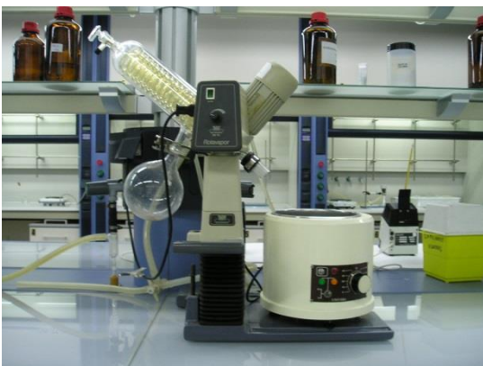
Figura 1: Rotavapor, equipo de destilación a vacío
