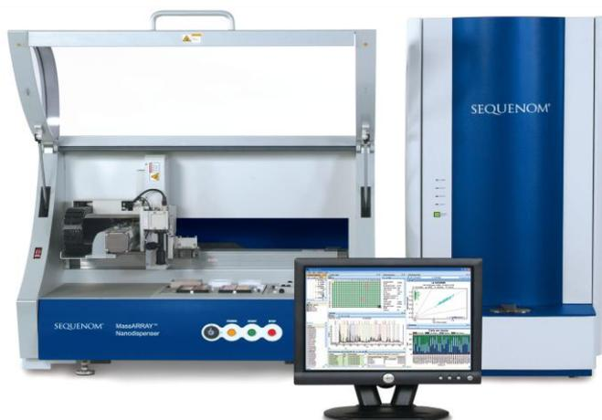
El núcleo del laboratorio lo forma el sistema Massarray Compact®, formado por un **robot nanodispensador**, que deposita las muestras procesadas en microplacas de 384 pocillos (Spectrochip®), y un **espectrómetro de masas** con la tecnología MALDI TOF, con el que se analizan las muestras de ADN contenidas en esas microplacas, lo que permite conocer la secuencia exacta de un fragmento de ADN o, siendo ésta conocida, la expresión del gen asociado a dicho fragmento.
