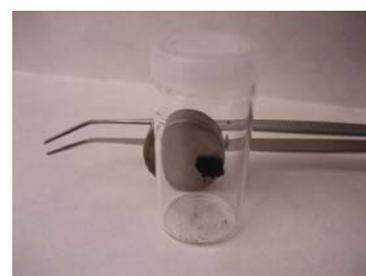
(I) Impresión controlada del precursor sobre sílice a escala sub-micrométrica, haciendo uso de técnicas nanolitográficas. (II) espinela generada a partir de un precursor soluble mediante tratamiento térmico, que se comporta como imán a temperatura ambiente.
