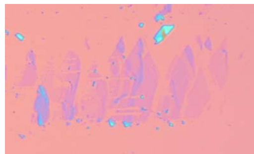
Monocapas de \text{TaS}_2 sobre \text{SiO}_2 .
