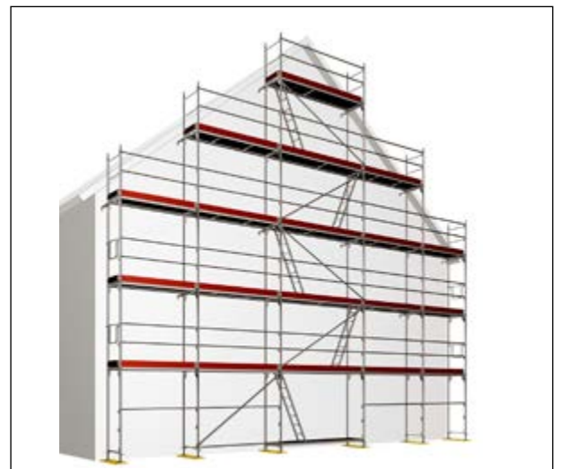
Figura 10. Esquema de distribución de accesos y amarres en andamio sin cubrición.
