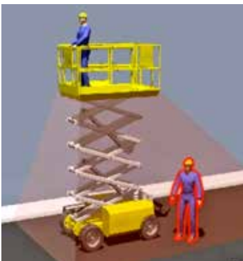
Figura 22. Control de presencia de operarios en proximidad.
