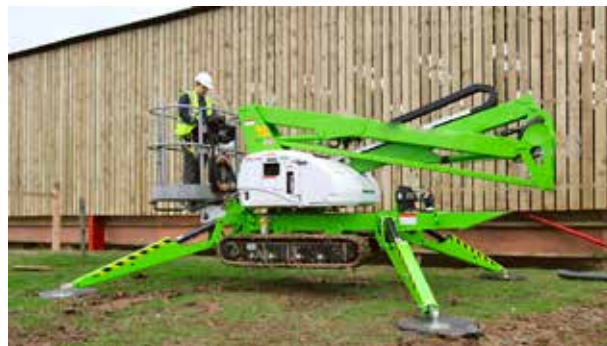
Figura 15. Estabilizadores hidráulicos con placa de apoyo.
