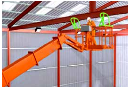
Figura 26. PEMP con sistema antiatrapamiento.
