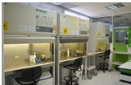
Fig. 32. Cabinas de bioseguridad de clase II con tecnología de flujo laminar (Fuente: fotografía proporcionada por un laboratorio participante)
