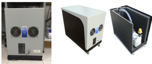
Fig. 30. Ejemplo de carcasa de aislamiento para bombas de vacío (Fuente: imágenes proporcionadas por un laboratorio participante)
