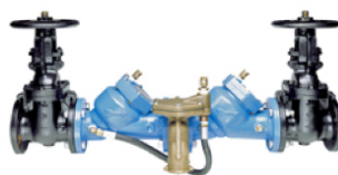
Fig. 27. Dispositivo de presión reducida que evita el flujo de retorno, incorpora dos válvulas de control y una válvula de escape situada entre ambas (Fuente: https://www.labdesignnews.com/article/2010/04/understanding-laboratory-plumbing-systems-water )
