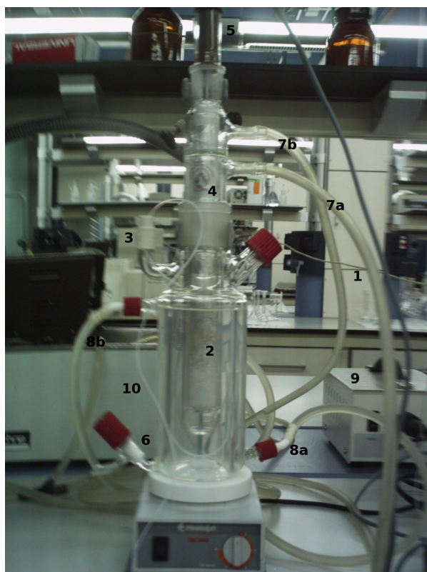
Figura 1: Reactor completament muntat: 1 Sensor del termoparell; 2 Cos central del reactor; 3 Boca d'admissió dels reactants; 4 Camisa de refrigeració del llum; 5 El llum en recipient de quars; 6 Clau per a la neteja del reactor; 7a,b Circuit de refrigeració del llum; 8a,b Circuit de refrigeració del cos del reactor; 9 Font d'alimentació del llum; 10 Tub de tefló de presa de mostra; 11 Boca d'admissió d'oxigen.
