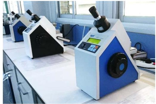
2. Sitúa la muestra en la superficie de trabajo. Para ello, coloca dos o tres gotas con ayuda de un cuentagotas, sobre la superficie limpia del **Prisma inferior** sin rallar su superficie.
