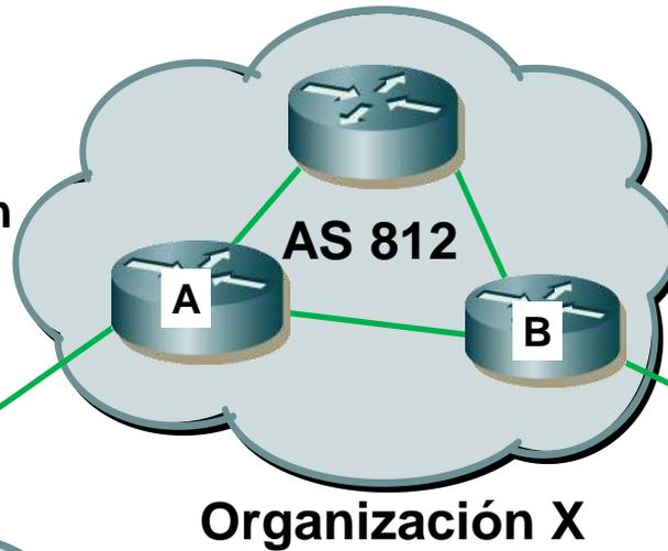
En caso de fallo de un proveedor el tráfico se reencamina de forma automática
