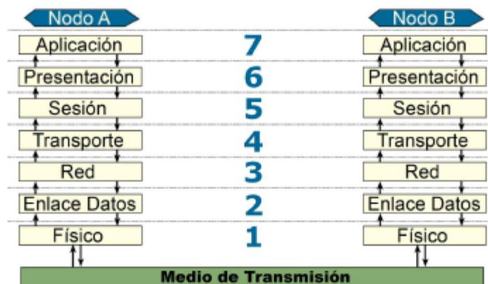
Figura 6. Modelo OSI para comunicación entre dos nodos.
