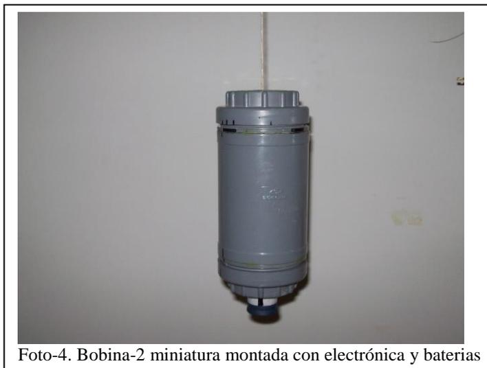
Foto-4. Bobina-2 miniatura montada con electrónica y baterías
