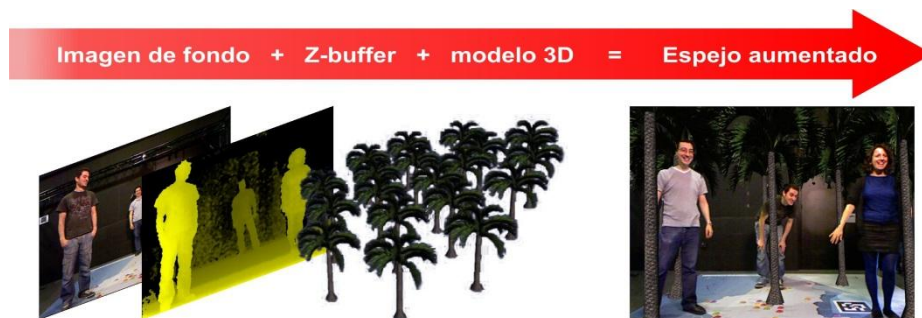
Fig. 5. Composición de una escena aumentada utilizando información de profundidad.
