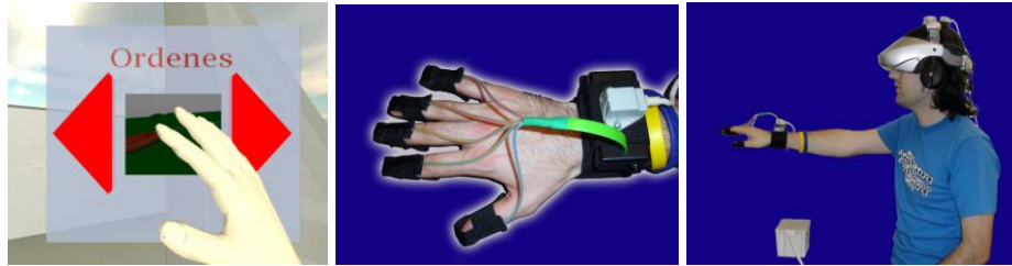
Fig. 2. Botonera y brazo virtual (izq); guante Thimble-Glove (centro); sistema completo(der).
