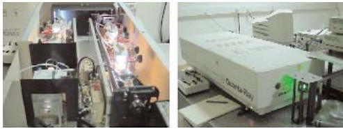
Figura 13: Un láser de Nd:YAG, a 1064 nm, doblado en frecuencia. A la izquierda, la tapa está quitada y se aprecian las lámparas de flash y el elemento doblador de frecuencia, en primer plano a la izquierda del todo. En este caso el elemento doblador es un cristal de KDP, que se encuentra en una cavidad sellada por ser hidrófilo. A la derecha, se aprecia la salida del haz doblado en frecuencia, a 532 nm, de color verde intenso.
