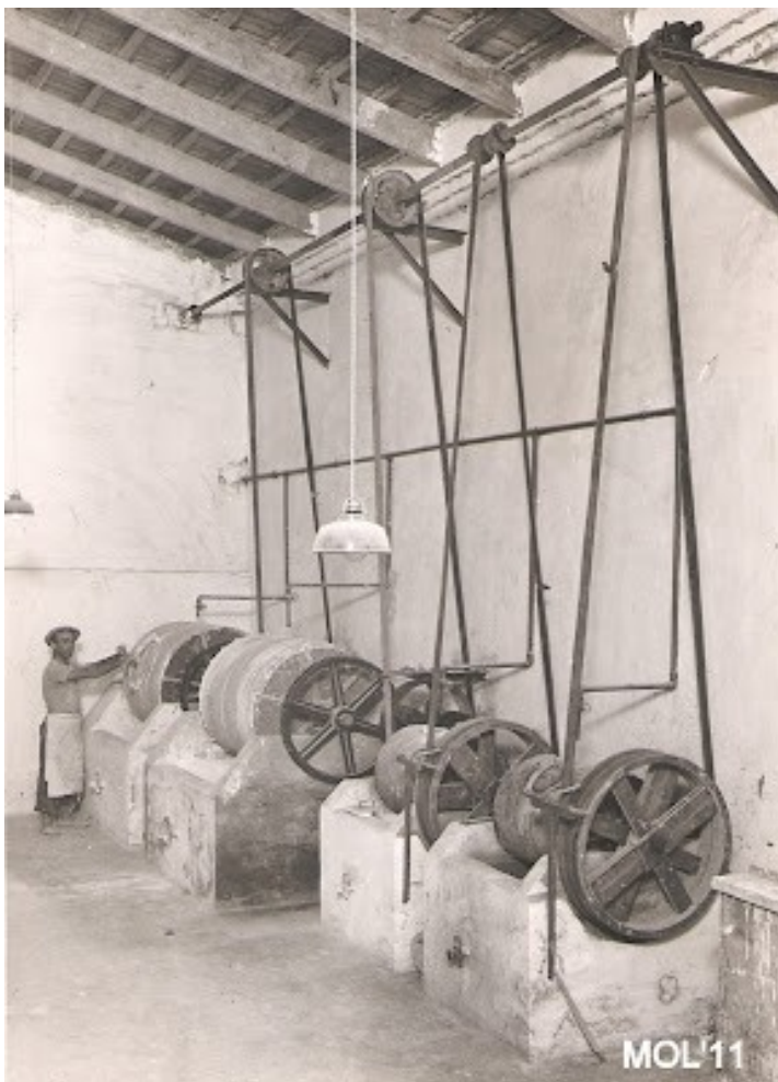
Figura 8. Los grandes tambores para el mezclado de caolín, feldespato, cuarzo y algunos otros aditivos para hacer más dúctiles las pastas de porcelana.
