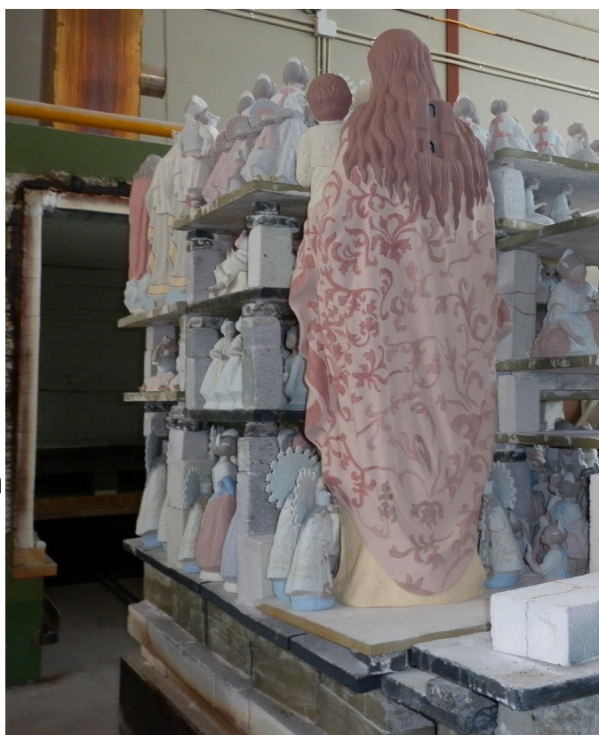
Figura 13. Armán. La gran imagen de la Virgen de la Seo, de Xàtiva, en la vagoneta de cocción, frente al horno.
