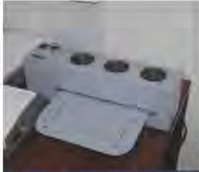
Forn Fusher per a realització d'imatges a relleu
