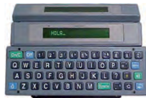
Comunicador electrònic amb veu sintetitzada
