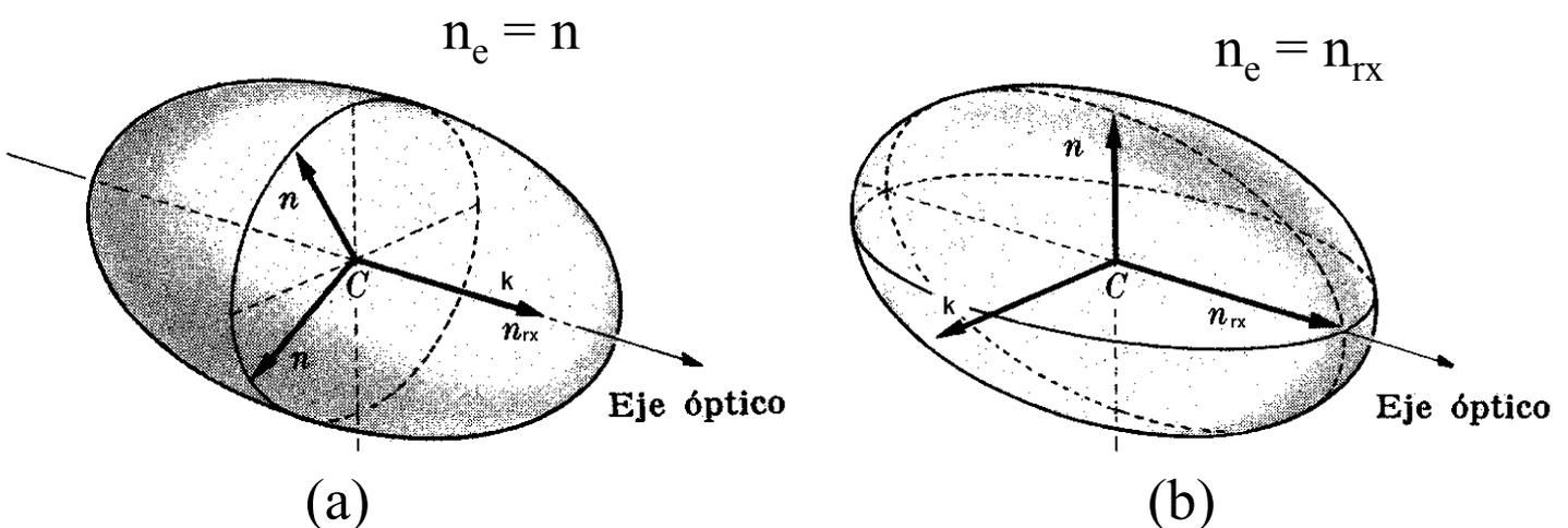
Si la luz se propaga en una dirección diferente de la del eje óptico, se generará un desfase entre las dos polarizaciones pues la velocidad de propagación es diferente. Este retraso se aprovecha para diseñar dispositivos que modifiquen la polarización de la luz.
