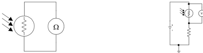
**Figura 1.-** Medida directa de la resistencia de la fotorresistencia con el multímetro o medida indirecta determinando la caída de tensión en un divisor resistivo.
