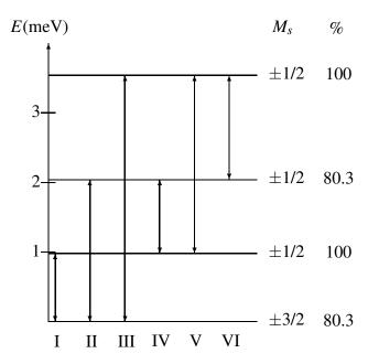
Figura 2.21: Esquema de niveles para el **Co**<sub>3</sub>**W**, incluyendo el valor del número cuántico de espín de la función predominante para cada nivel.
