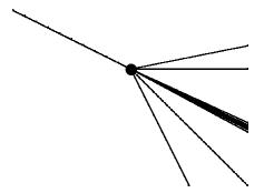
Figura 1.6: Esquema de la trayectoria del haz de neutrones, ilustrando las desviaciones que experimentan los neutrones (⋅) al interaccionar con la muestra, en la cápsula que la contiene (●). La mayoría de los neutrones prosiguen sin interacción apreciable, y una minoría toma o cede energía, y se desvía un cierto ángulo.
