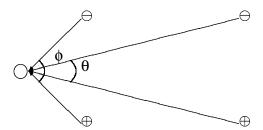
Figura 3.5: Efecto de la distancia en el campo eléctrico que un dipolo  $(\oplus \ominus)$  del baño ejerce sobre un átomo  $(\bigcirc)$  del fragmento central: distancias crecientes implican ángulos decrecientes  $(\theta < \phi)$ , y campos eléctricos efectivos decrecientes.
