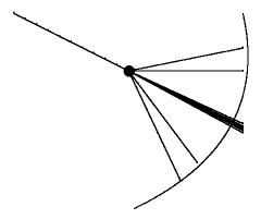
Figura A.1: Detección de los distintos haces de neutrones. Toda la pared curva está forrada de detectores individuales. La zona lineal, donde impactan todos los neutrones que no han interaccionado con la muestra, tiene un escudo, para absorber el impacto de la radiación.
