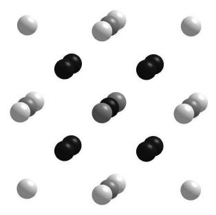
Figura 3.4: Representación idealizada de un baño de cargas puntuales. La molécula central, que contiene al fragmento activo, se representa como una esfera oscura. A distancias crecientes, y en tonos cada vez más claros, hay tres 'conchas': un cubo de 8 esferas (oscuras), un octaedro de 6 (tono medio), y un cuboctaedro de 12 (claras).
