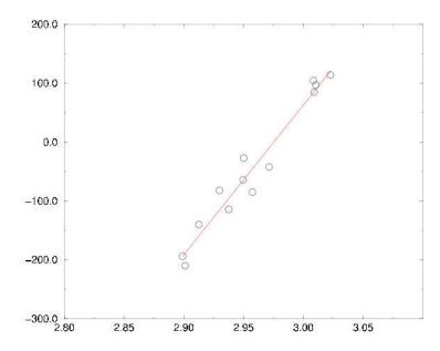
Figura 4.14: Correlación entre la distancia vanadio-vanadio y el canje magnético calculado entre ellos, para pares que comparten aristas.
