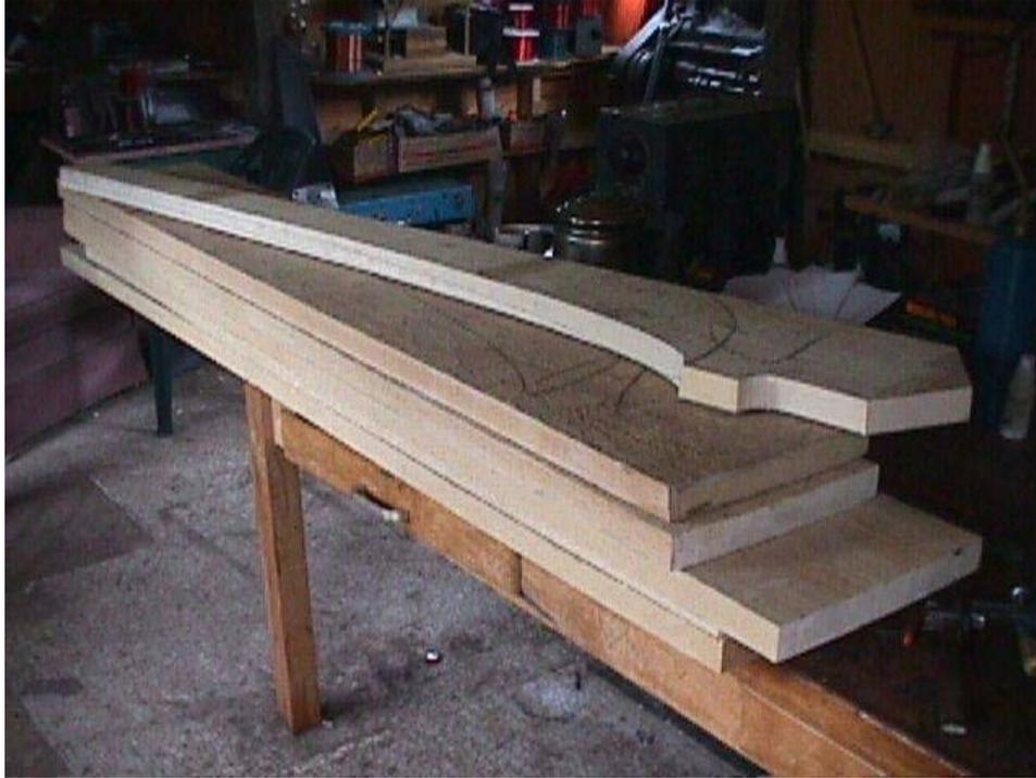
Empezamos con tablas de 5 pies de largo, 7 ½" de ancho y 2" de espesor. Luego dibujamos el contorno de un aspa y lo cortamos. Eso nos da una plantilla del contorno de las tres aspas.
