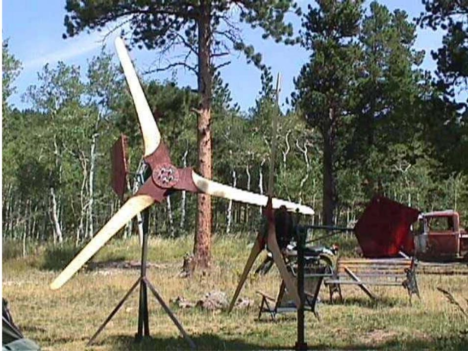
Y aquí está todo listo. Ahora lo que tenemos que hacer es balancear las aspas, hacer el circuito eléctrico y poner funcionar la turbina. Para balancear las aspas la impulsamos a mano y determinamos qué lado pesa más al lado opuesto colocamos pequeños trozos de plomo con unos tornillos. A veces basta con arandelas.
