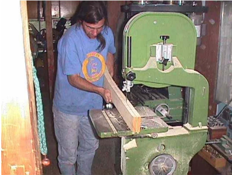
Como se ve en el dibujo anterior, la punta del aspa es de  $\frac{3}{8}$ " de espesor y en el eje es de espesor completo. Hay que quitar bastante material. Una sierra es útil en el primer paso. Debemos dejar algo de espesor extra para prevenir errores.
