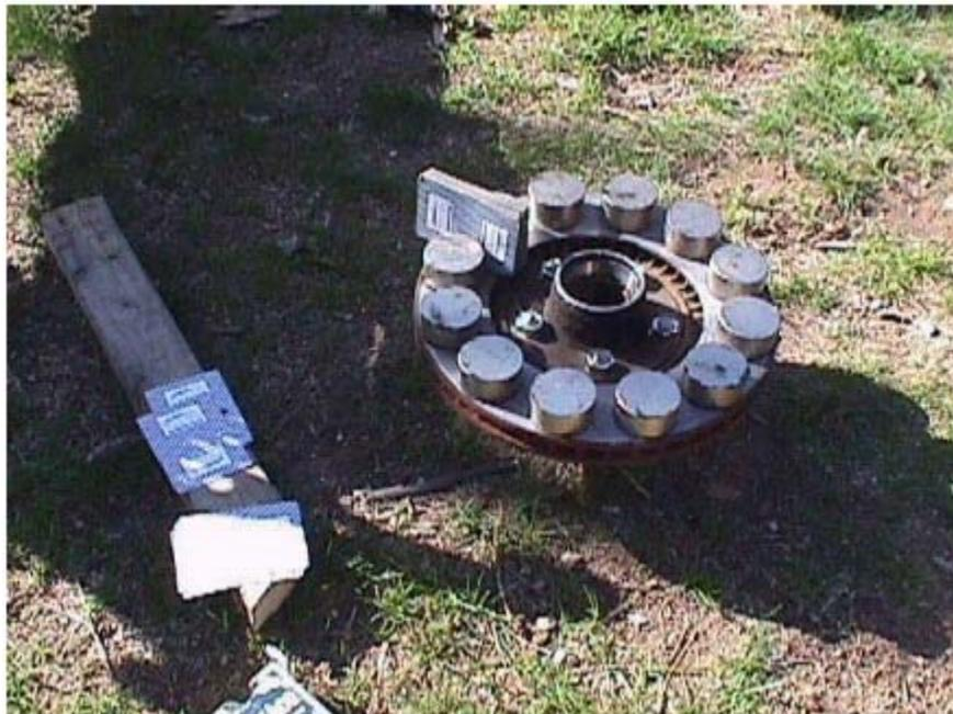
Los imanes se colocan sobre el disco del freno alternado sus polos. Primeramente los colocamos distanciados a ojo. Luego usamos cuñas delgadas (Barajas) hasta que queden perfectamente espaciados. En nuestro caso la distancia entre los imanes resultó ser  $\frac{1}{2}$  pulgada (O exactamente 49 barajas).
