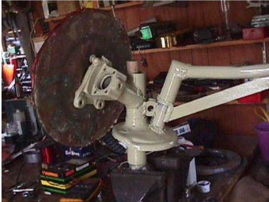
La foto anterior muestra el chasis con su veleta. La pintura empleada se basa en resina epóxica para evitar la oxidación de los elementos.
