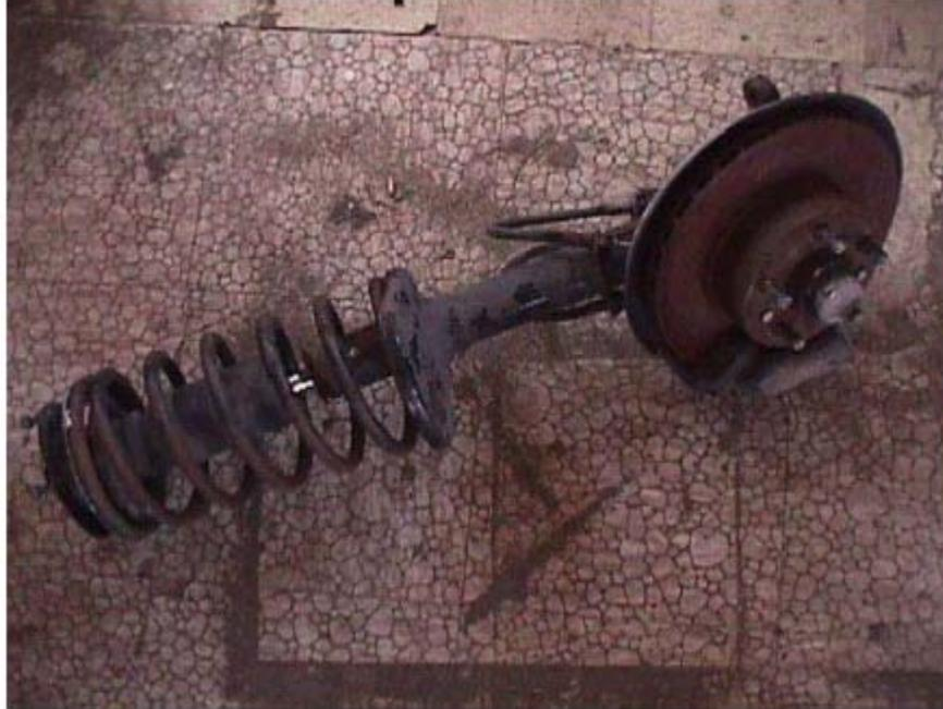
Con ésta pieza es la que generalmente comenzamos. Se trata de la armazón de la punta de eje delantera de un automóvil Volvo 240. Las piezas de Volvo son muy buenas. Por tratarse de automóviles de tracción trasera su tren delantero se consigue a un precio relativamente económico en los cementerios de automóviles. Los Volvo son automóviles relativamente pesados, de manera que sus rodamientos son grandes y sus discos de freno suelen ser más grandes que los de la mayoría de vehículos.
