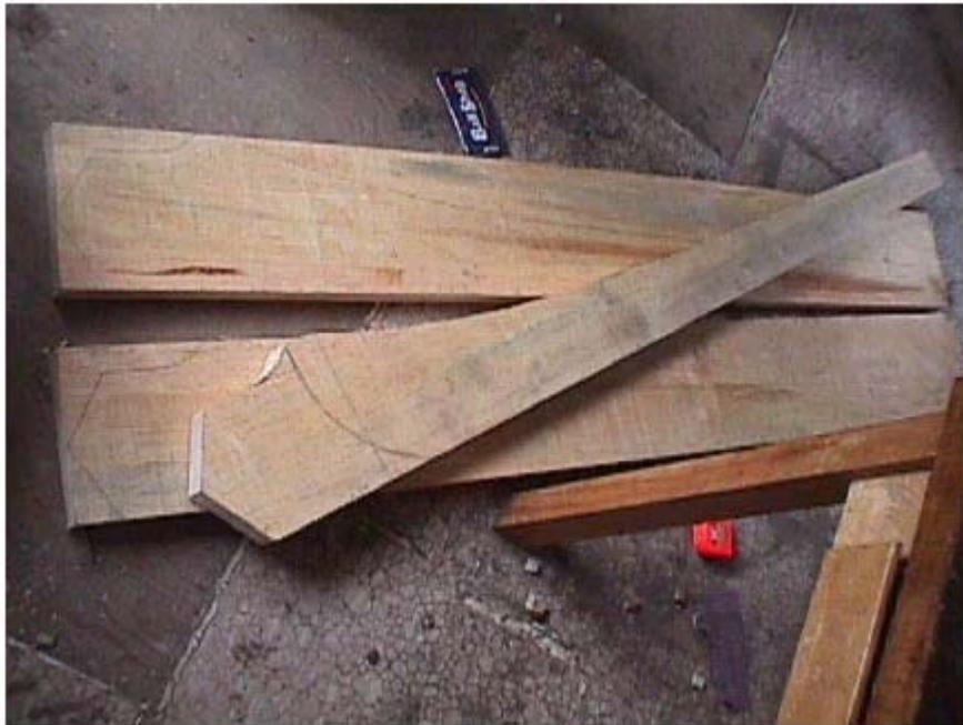
Las aspas están hechas de madera de 20 centímetros de ancho por 37 mm de espesor. Cada una mide 1 ½ metros de largo. Observe que hicimos una plantilla con la primera para cortar las demás.
