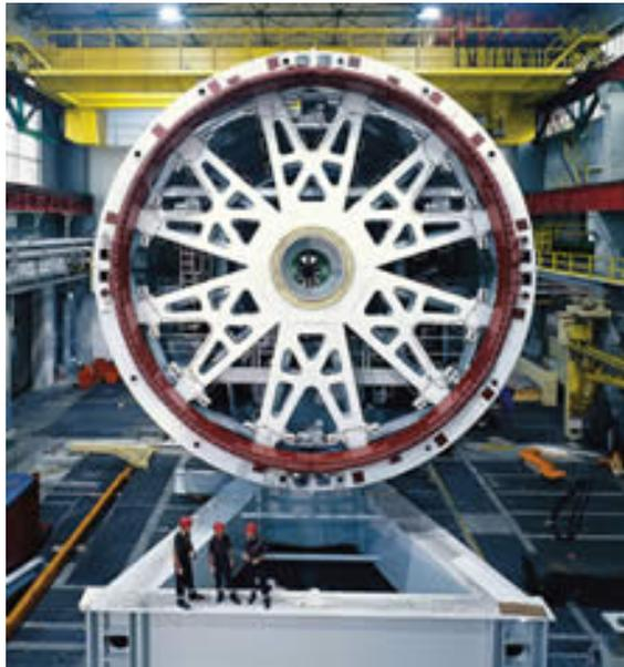
Figura 2.18: Rotor del alternador del E-112.
