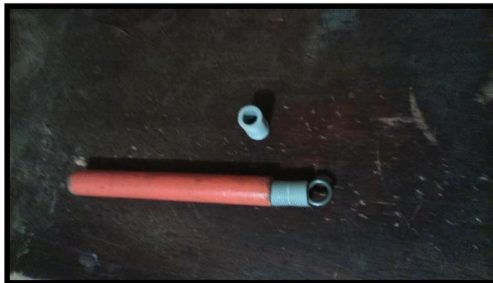
2.2) Colocamos el tubo de pvc, y entornillamos con fuerza el tornillo de aro.
