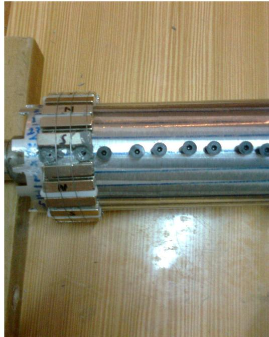
4.- Se cubren los imanes con resina Poxilina, para formar una capa que abrace aun mas a los imanes y haga cuerpo con los hilos de acero.
