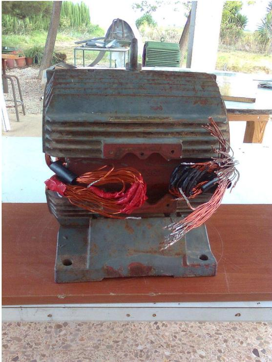
En la foto contigua, se muestra el motor-generador con los tres bobinados ya terminados
