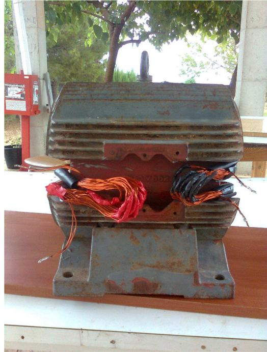
En la foto superior derecha se muestran dos bobinas ya terminadas. En las fotos siguientes se muestra como se realiza la tercera bobina en el estator.
