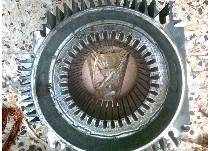
Para rebobinar el motor utilizaremos hilo de 1 mm. de diámetro. Usaremos un manojo de 6 hilos de este diámetro que bobinaremos conjuntamente. De este modo se puede llenar casi completamente el hueco entre dientes. Posteriormente, se decidirá conectar los hilos de cobre según el potencial que se decida que debe generar el aerogenerador.
