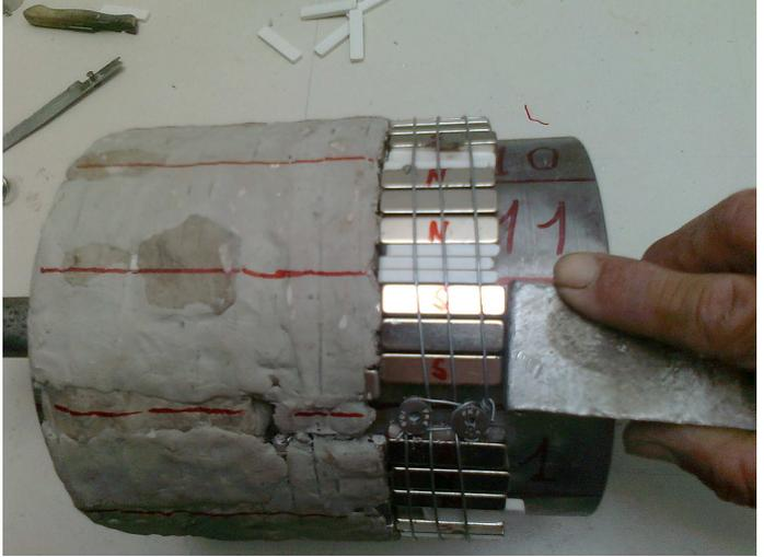
Rotor totalmente terminado, con los imanes recubiertos de Poxilina, cuya misión es doble, reforzar al hilo de hierro que sujeta los imanes al tubo de hierro y cubrir los imanes para evitar su posible oxidación.
