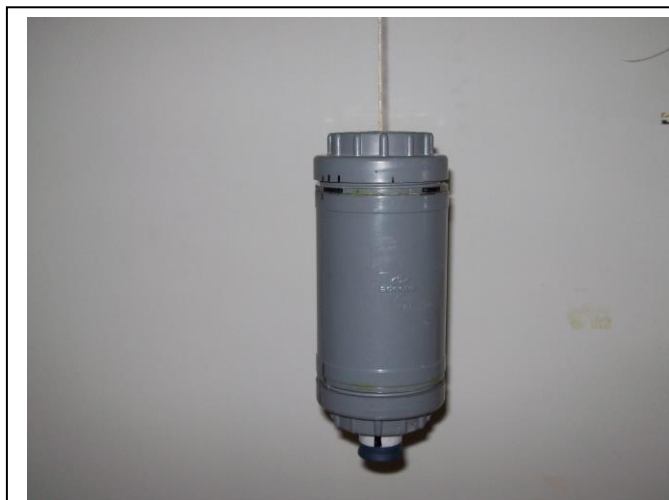
Foto-5. Bobina miniatura montada con electrónica y baterías
