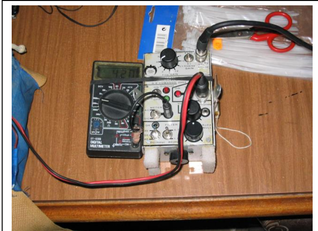
Foto-10. Receptor con voltímetro y alimentación
