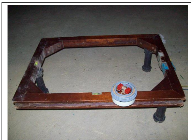
Foto-4. Comparación Bobina –bobina miniatura
