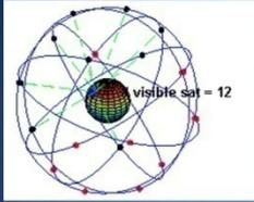
El GPS funciona mediante una red de 24 satélites en órbita sobre el globo, a 20.200 km, con trayectorias sincronizadas para cubrir toda la superficie de la Tierra. Cuando se desea determinar la posición, el receptor que se utiliza para ello localiza automáticamente como mínimo tres satélites de la red y mediante un método similar a la triangulación, te indica la posición absoluta o coordenadas reales del punto de medición. Nos indica también la altura.
