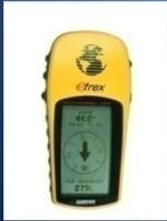
Con las coordenadas nos vamos al mapa, las situamos y sabemos donde estamos. La precisión actual, con GPS normal, esta sobre los 5 m en latitud/longitud y de unos 15 m en altura. Los GPS profesionales tiene márgenes de error de centímetros.
